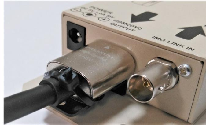
付属の CL-1 金具を予め本体へ取付けます。取付けネジは本体に出荷時に実装済みです。(M3 ビス) HDMI プラグを挿入し、付属の束線バンドでプラグ後部を固定します。束線バンドの不要部分は切り取ってください。
